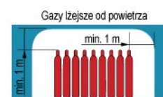
Rys. 11. Wymiary stref ochronnych dla butli z gazami palnymi podczas przechowywania na wolnym powietrzu
