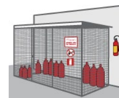
Rys. 10. Magazyn gazów technicznych na wolnym powietrzu
