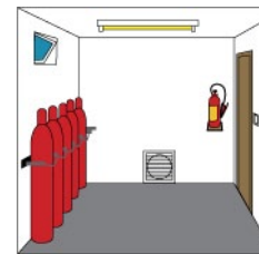
Rys. 7. Magazyn gazów technicznych w budynku
